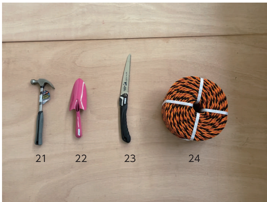
21, グリップネイルハンマー大 4本 22, 移植ごて 20本 23, シャクソー替刃式折込鋸 210mm 4本 24, 標識トラロープ12mm長さ約100m 2巻
